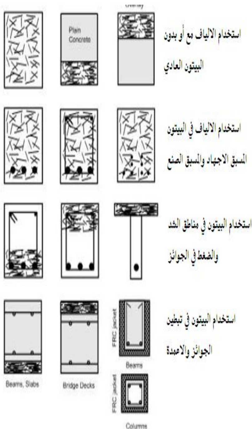
الشكل (11) يبين استخدام البيتون الليفي في مقاطع إنشائية متنوعة [16]
