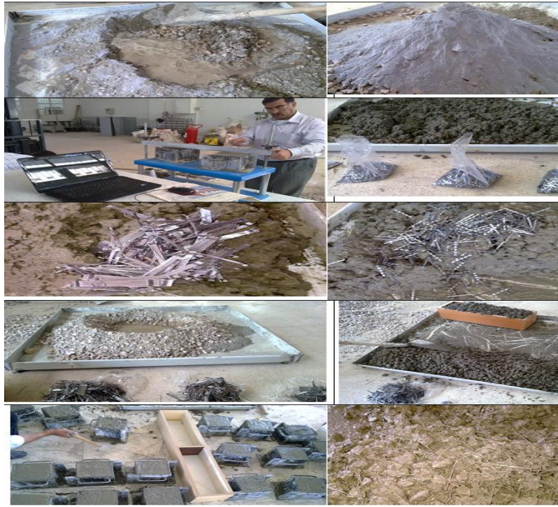
الشكل (19) يبين القوالب المعدنية والخشبية وجهاز الرج المستخدم في البحث
