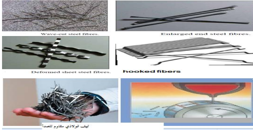
الشكل (3) يبين أشكالا مختلفة للألياف الفولاذية [5]
